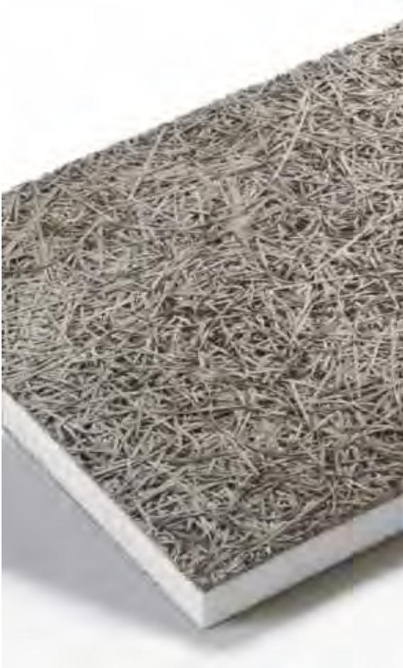
Dreischichtplatte mit einem Kern aus expandiertem Polystyrol (Styropor®) und zwei Schichten mineralischer Holzwole. Zementgebände und Zusätze binden Holzwole und Kern in eine geschlossene Einheit. Die Oberfläche sichert eine mechanische Widerstandsfähigkeit der Platte und eine gute Haftung für Kleber und Mörtel.
