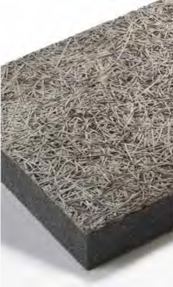
Dreischichtplatte mit einem Kern aus expandiertem Polystyrol mit verbesserter Dämmleistung aus der Reihe Neopor® und zwei Schichten mineralischer Holzwole. Zementgebände und Zusätze binden Holzwole und Kern in eine geschlossene Einheit. Die Oberfläche sichert eine mechanische Widerstandsfähigkeit der Platte und eine gute Haftung für Kleber und Mörtel.
