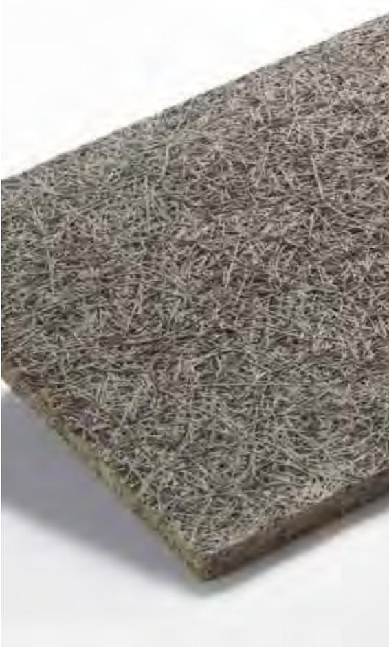
Platte aus mineralischer Holzwolle mit feiner Struktur, Zementgebände und Zusätze binden die Holzwolle in eine geschlossene Einheit. Wegen Poreninnenstruktur und Formfläche ist hochwirksam als Schallabsorber. Zwischen Herstellung wird Aussehen der Fläche kontrolliert, weil die Platten nach der Einbau sichtbar bleiben.
