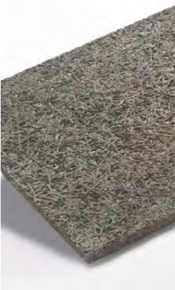
Platte aus mineralischer Holzwolle, Zementgebände und Zusätze binden die Holzwolle in eine geschlossene Einheit. Mit dem Mineralisierungsverfahren wird der Brandwiderstand der Holzwolle erheblich erhöht. Eine weitere positive Eigenschaft der Platte ist die Schalldämmung. Wegen Poreninnenstruktur und Formfläche wirkt als vorzüglicher Schallabsorber in Schallschutzsystemen.
